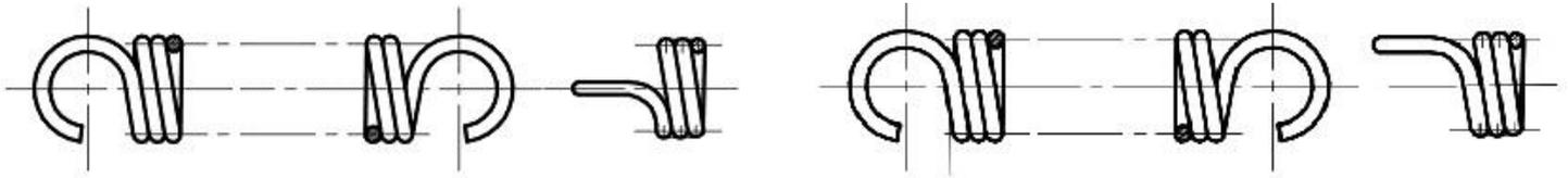
Зацеп расположен в плоскости под углом к оси пружины фасонного типа
