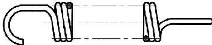
Зацепы по центру в одной плоскости, вход в зацеп с одной стороны    Зацепы в одной плоскости по образующей, вход в зацеп с одной стороны
