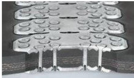
Лента конвейера имеет ограниченную длину отрезка. Отрезки соединяются между собой при помощи креплений разного рода. Тип крепления зависит от целевого назначения ленты, типа грузов, которые транспортируются, а также от других конструктивных особенностей. Механические соединения лент, используемых в горнодобывающей и тяжелой промышленности, а также для транспортировки абразивных материалов, должны отличаться повышенной прочностью и износостойкостью.
