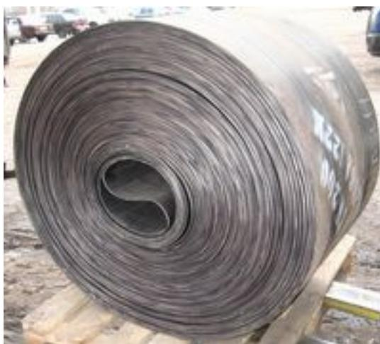
Лента резиноканевая в Российской Федерации производится в соответствии с ГОСТ 20-85. Данный стандарт распространяется на используемые на транспортерах с желобчатыми и плоскими роlikоопорами ленты с резиновыми обкладками и резиноканевым несущим каркасом, которые применяются для транспортировки сыпучих, кусковых, штучных грузов.
